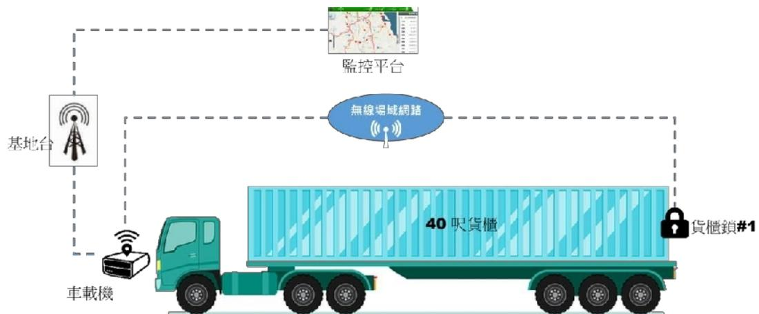
圖 5、物聯網全時監控服務系統架構圖-透過車載機回傳 (40 呎貨櫃)
