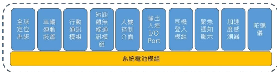
圖 2、車載機系統架構圖
