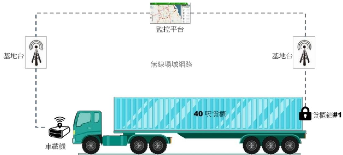
圖 3、物聯網全時監控服務系統架構圖-獨立回傳 (40 呎貨櫃)
