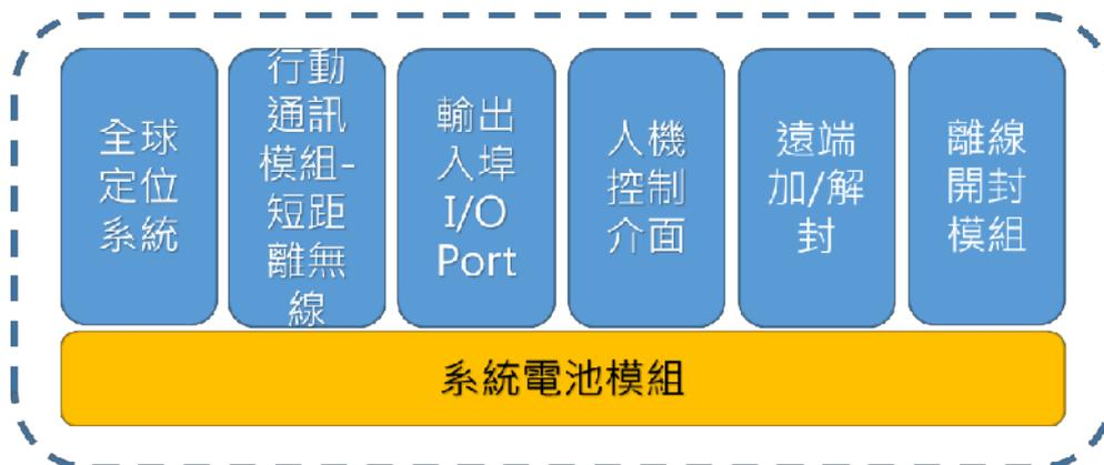
圖 3、車機封條透過車機回傳系統架構圖
