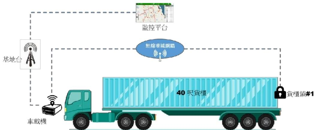
圖 6、物聯網全時監控服務系統架構圖-透過車載機回傳 (40 呎貨櫃)
