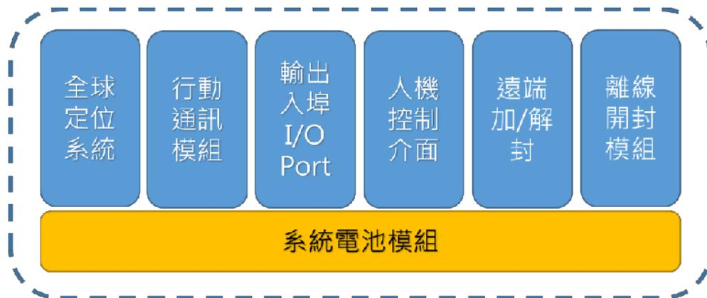
圖 2、車機封條獨立回傳系統架構圖
