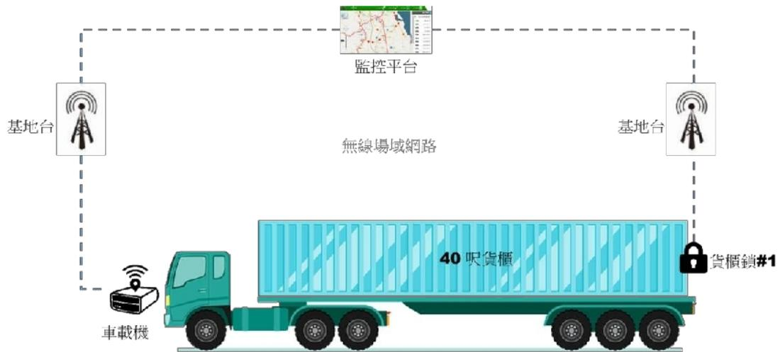
圖 4、物聯網全時監控服務系統架構圖-獨立回傳 (40 呎貨櫃)
